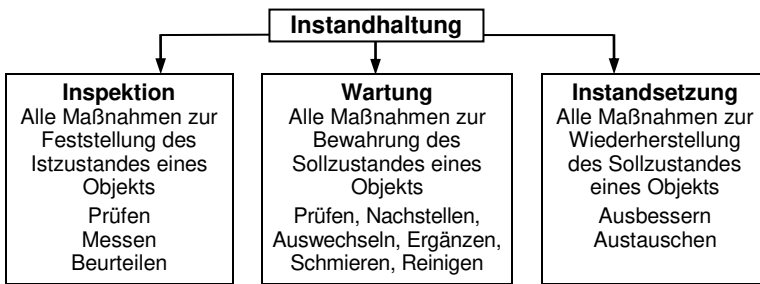
Abb. 10.8 Maßnahmen zur Instandhaltung (Inspektion, Wartung und Instandsetzung, mod. nach BIRUS)
